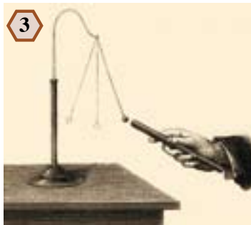
Le pendule électrique à balle de sureau permet de simplifier l'expérience de Dufay.
