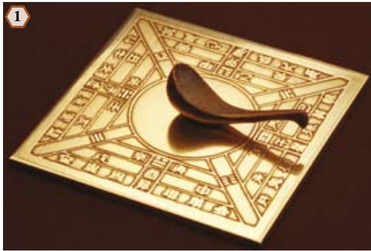
Reproduction d'une boussole chinoise antique de la dynastie de Han (206 av. J.-C. - 220 apr. J.-C.) selon un modèle conservé au Musée de l'Histoire de la Chine à Pékin (Beijing). Cette reproduction est fabriquée par l'Institut central de recherche sur le fer et l'acier, à Pékin, et elle pointe vers le Sud. Elle est vendue pour des fins éducatives et comme souvenir.
