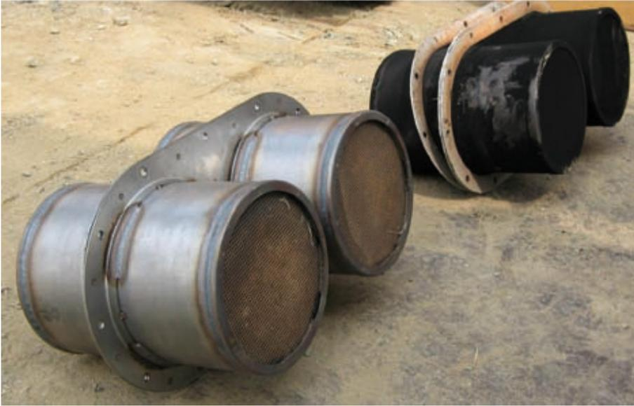
**Figure 4.25** – Comparaison de l'état des filtres à particules après usage dans les mêmes conditions. L'encrassement du filtre de droite, qui a été utilisé avec du carburant diesel ordinaire, est très éloquent. L'amélioration de la combustion avec le carburant émulsifié à l'eau est bien visible sur le filtre de gauche en avant-plan.
