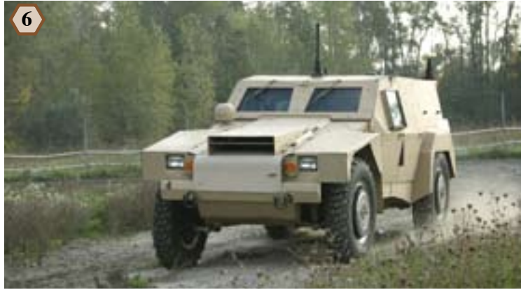
Le RST-V de General Dynamics, dévoilé en 2004, est muni de quatre moteurs-roues et d'un générateur diesel. Sa consommation est moins de la moitié de celle d'un véhicule conventionnel du même calibre (gracieuseté de General Dynamics Land Systems).
