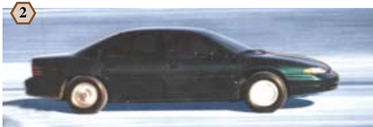
L'automobile électrique dévoilée en 1994 par Hydro-Québec. Cette Chrysler Intrepid transformée possède deux moteurs-roues à l'arrière. Le prototype de 1995 était équipé de quatre moteurs-roues (archives du journal Le Devoir, de Montréal).
