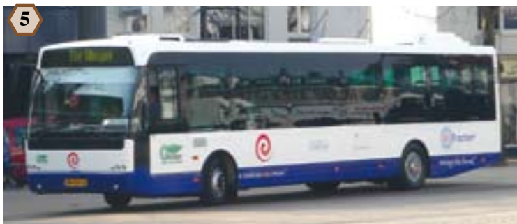
Le Whisper est un autobus hybride expérimental de la compagnie e-Traction, mû par deux moteurs-roues à l'arrière, alimentés par des batteries. Celles-ci sont rechargées à l'aide d'un générateur diesel de 50 kW à bord du véhicule, ou sur le réseau électrique. Il peut rouler une heure en mode purement électrique et consomme trois fois moins de carburant (gracieuseté de e-Traction).
