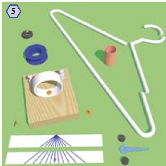
Les composants utilisés pour construire le galvanomètre.
