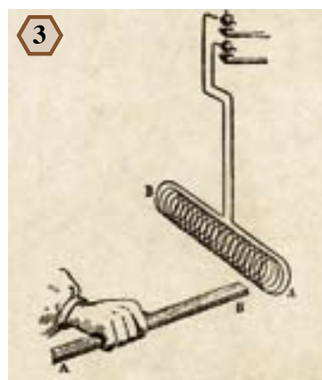
Expérience réalisée par Ampère, démontrant qu'un solénoïde de courant se comporte comme un barreau aimanté.
